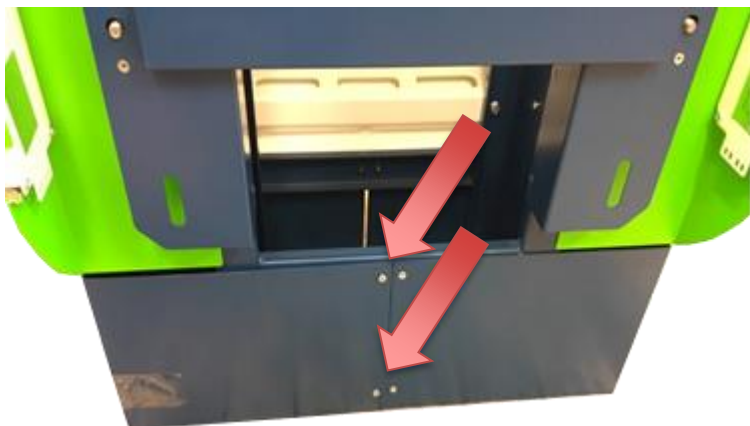
Obrázek 5: Umístění šroubů spodního krytu
