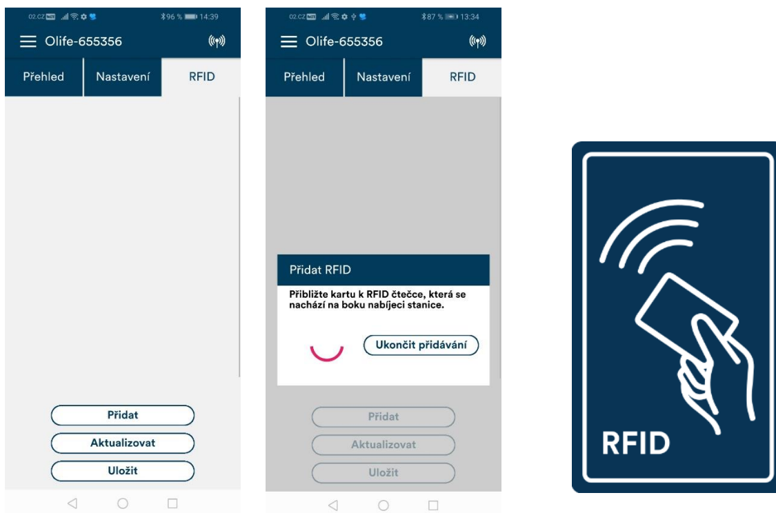
Obrázek 6: RFID menu pro přidávání karet + symbol na stanici ke kterému se přikládají karty a čipy
